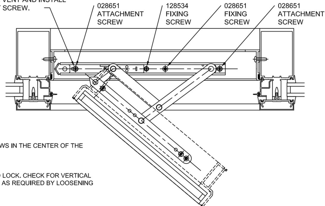
POSITION THE SCREWS IN THE CENTER OF THE 4-BAR HINGE SLOTS.
